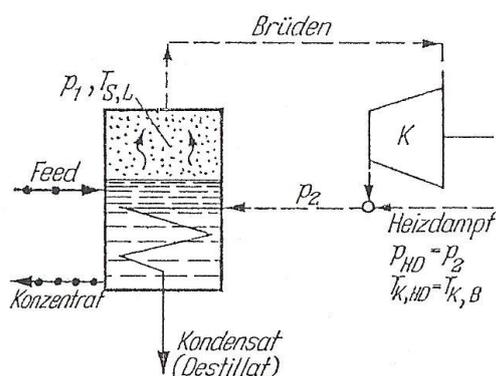
Abb.4: Einkörperverdampfer mit Brüdenkompression (Quelle: Grassmann Widmer/Einführung in die TVT)
