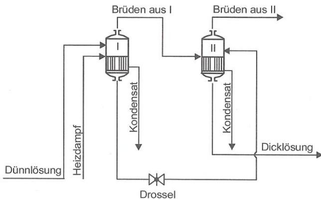
Abb.6: Zweistufige Verdampferanlage im Gleichstrombetrieb
