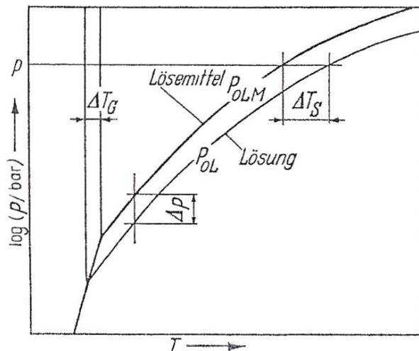
Abb.1: Dampfdruckkurven Lösungsmittel und Lösung (Quelle: Grassmann Widmer/Einführung in die TVT, überarbeitet)
