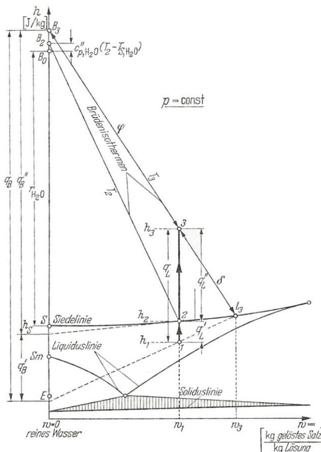
Abb.2: Verdampfung einer Lösung im (h, w)-Diagramm (Quelle: Grassmann, Widmer / Einführung in die TVT)
