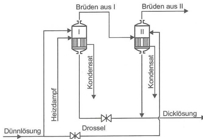
Abb.5: Zweistufige Verdampferanlage im Parallelbetrieb (Quelle: Schwister/Taschenbuch der Verfahrenstechnik)
