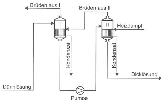
Abb.7: Zweistufige Verdampferanlage im Gegenstrombetrieb
